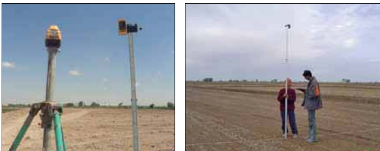
Рис. 4. Лазерный передатчик и ручной лазерный приемник прикрепленный к телескопической линейке. На размеченных точках оператор считывает показания на линейке, когда прикрепленный лазерный приемник начинает издавать сигнал улавливания лазерного луча от передатчика.
