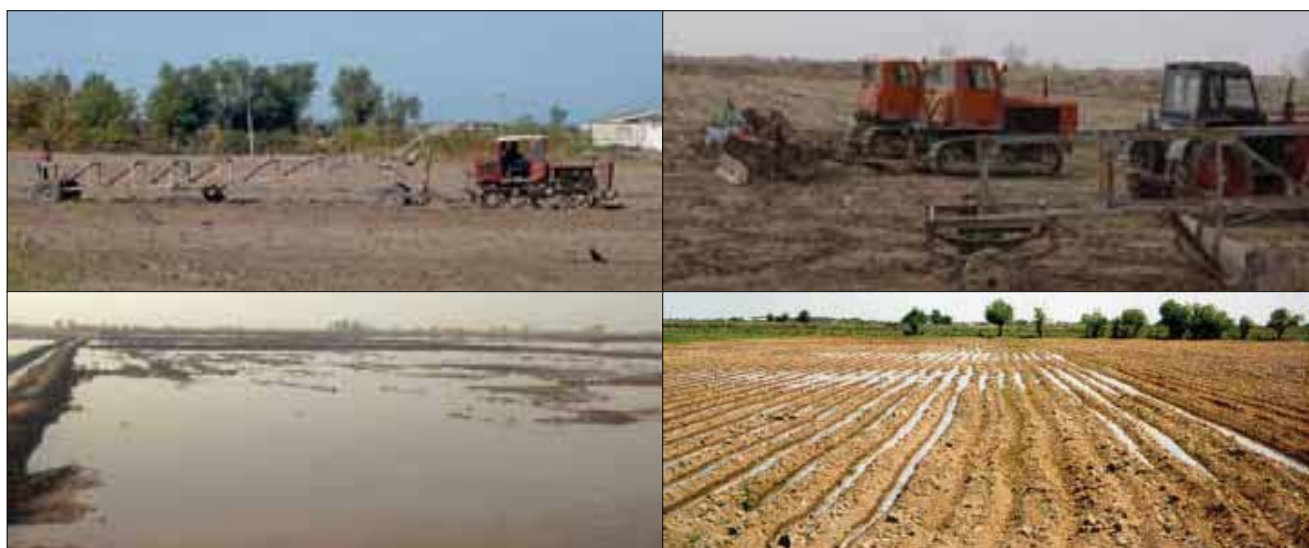
Рис. 1. Длиннобазовый планировщик, мола выравнивающая, и неровности на полях приводящие к неравномерному распределению воды
